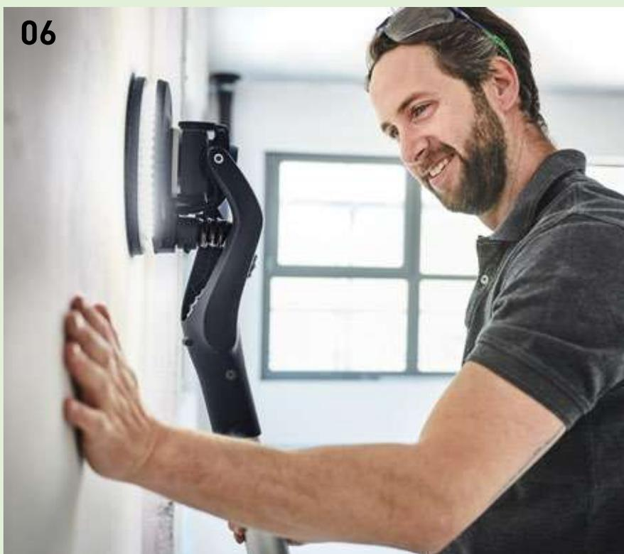
**06 Poncer et contrôler.** Grâce au grand plateau de ponçage (ø 225) et à la dépression réglable, vous obtenez une surface homogène sans rayures. La lampe rasante vous éclaire sur le niveau de qualité atteint, et ce dès le démarrage de la PLANEX 2 225 avec son anneau lumineux.
