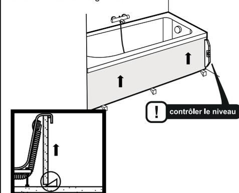
**11.** Placer les butées provisoires de maintien.
