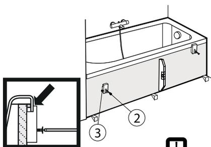
**Attendre le séchage complet de la colle pour assemblage avant de poser le décor ou le carrelage.**
