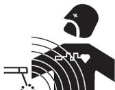
Elektrischer Strom verursacht beim Durchfluss durch einen Leiter elektrische und magnetische Felder (EMF). Der Schweißstrom produziert ein elektromagnetisches Feld um den Schweißstromkreis und um das Schweißgerät herum.
