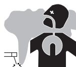
Kouř vznikající při svařování obsahuje škodlivé plyny a výpary. Zajistit dostatek čerstvého vzduchu, může být nutné používat způsobilý dýchací přístroj. Pokud nedostačuje větrání, použijte ochrannou dýchací kuklu s přívodem vzduchu. V případě nejasnosti, zda dostačuje výkon odsávacího zařízení, porovnejte naměřené emisní hodnoty škodlivin s povolenými limity.
