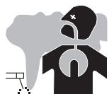
I fumi, gas e polveri emessi dalla saldatura sono pericolosi per la salute. È necessario prevedere una ventilazione sufficiente e a volte è necessario un apporto d'aria. Una maschera ad aria fresca potrebbe essere una soluzione in caso di aerazione insufficiente.
