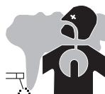
Beim Schweißen entstehender Rauch, Gas und Staub sind gesundheitsschädlich. Eine ausreichende Lüftung ist vorzusehen, in manchen Fällen ist eine Luftzufuhr erforderlich. Im Falle einer unzureichender Belüftung kann eine Frischluftmaske eine Lösung sein. Effizienz der Luftzufuhr gemäß Sicherheitsnormen überprüfen.
