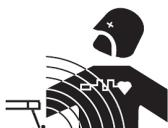
Průchod elektrického proudu v některých vodivých částečkách způsobuje vznik lokalizovaných elektromagnetických polí (EMF). Svařovací proud způsobuje elektromagnetickou poli v okolí svařovacího obvodu.
