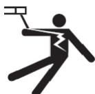
Het elektrische netwerk dat wordt gebruikt moet altijd geaard zijn. Gebruik het op de veiligheidstabel aanbevolen type zekering. Een elektrische schok kan, direct of indirect, ernstige en zelfs dodelijke ongelukken veroorzaken.
