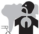
Выделяемые при сварке дым, газ и пыль опасны для здоровья. Вентиляция должна быть достаточной, и может потребоваться дополнительная подача воздуха. При недостаточной вентиляции можно воспользоваться маской сварщика-рееспиратором.
