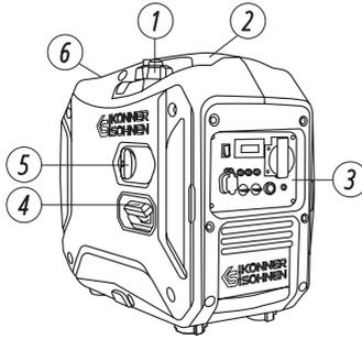
1. Évent du bouchon du réservoir de carburant
