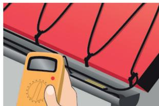
8. Vérifiez à nouveau et comparez la résistance d'isolation. La valeur mesurée ne doit pas être inférieure à 50 MΩ.
