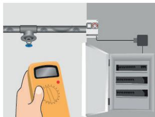
8. Revérifiez la résistance d'isolation. Raccordez les câbles aux boîtiers de raccordement et au tableau de distribution.
