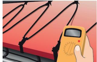
6. Installez le(s) câble(s) sur le toit, dans les gouttières et les descentes de gouttière. Vérifiez à nouveau et comparez la résistance d'isolation.
