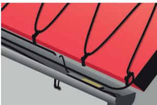
7. Installez les sondes et étendez les câbles de sonde, les câbles d'extrémité/liasons froides et placez les raccordements à sec. Scellez toutes les pénétrations, par exemple à travers les toits et les murs.
