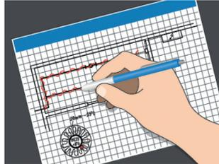
2. Dessinez un plan de positionnement des câble(s), sondes et thermostat, raccords de câble, liaison froide, boîtier de raccordement, chemins de câble et tableau de distribution.
