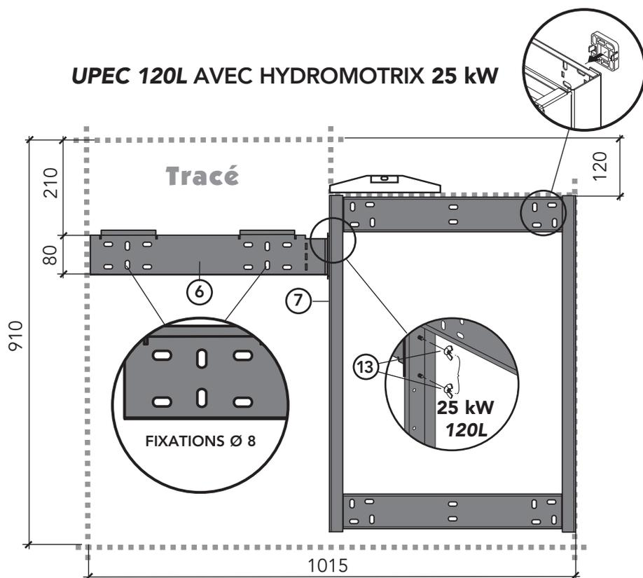
**i** Si l'UPEC 120 est associé à une hydromotrix 25 kW, monter les cales à l'arrière du dossier avant de le fixer au mur.
