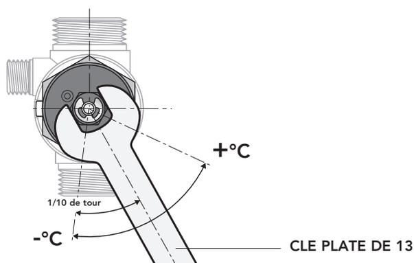
Le RTA est préréglé pour une température de sortie maximale comprise entre 45 et 50°C, point idéal de fonctionnement pour le meilleur rapport confort d'utilisation et économie d'énergie.
