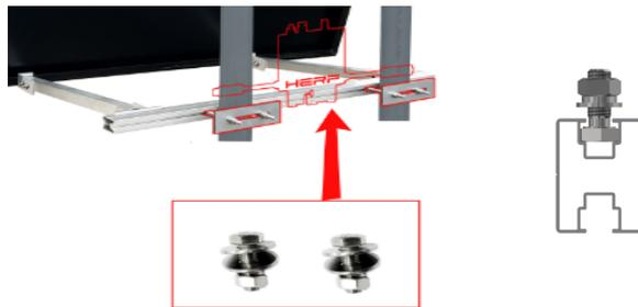
4. Accrochez le système au balcon, placez l'arceau long avec le garde-corps et verrouillez l'installation :
