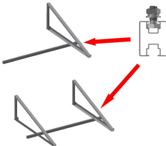
3. Retirer le crochet préparé, comme indiqué sur la figure, l'aligner sur la position du trou de passage et le verrouiller. Installer des couvercles de protection aux deux extrémités du rail de suspension.
