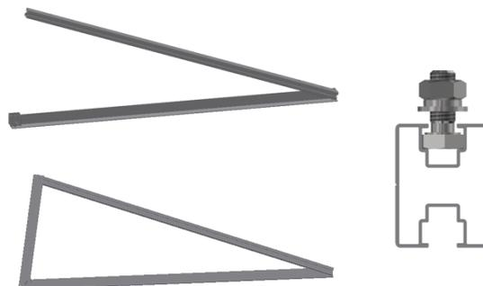
2. Placer le rail de suspension et le pré-verrouiller avec des boulons M8 \* 20, préinstaller deux boulons M8 \* 20 sur le rail de suspension (pour l'installation de l'onduleur), répéter l'étape 1 pour installer une autre partie de la structure du trépied en fonction de l'espacement des trous de la carte de la batterie, et utiliser un ruban à mesurer pour mesurer son espacement à l'endroit approprié.
