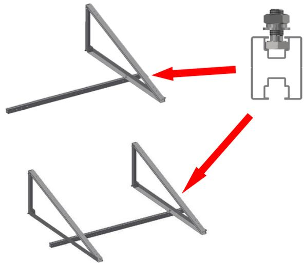
(2) Retirer le crochet préparé, comme indiqué sur la figure, l'aligner sur la position du trou de passage et le verrouiller. Installer des couvercles de protection aux deux extrémités de la voie de suspension.
