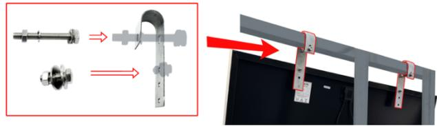
2. Installer le support sur le module avec :
