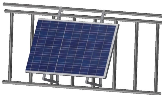
7. Enfin, l'arceau long est placé au niveau de la connexion avec le garde-corps. Verrouillez deux jeux de boulons M8 \* 90 pour terminer l'installation et compléter l'ensemble des produits de la console.
