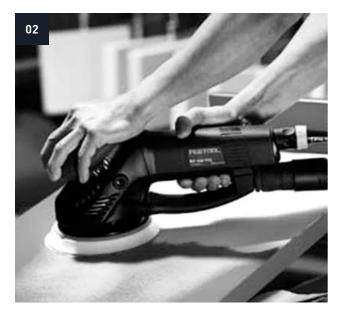
Passez lentement la ponceuse sur la surface pour retirer le revêtement endommagé.
