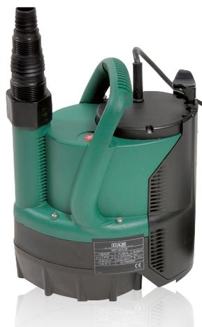
Les **VERTY NOVA** sont des pompes submersibles avec flotteur intégré spécialement conçues pour des puisards d'évacuation aux dimensions réduites (minimum 20 cm x 20 cm). Destinées au pompage d'eaux propres contenant des particules solides d'un diamètre maximum 5 mm. La température du liquide à pomper ne doit jamais dépasser les 35°C.
