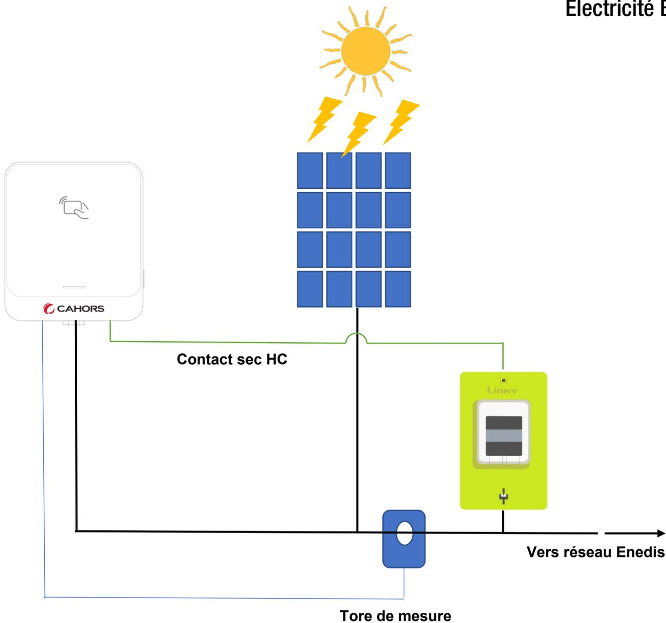
Schéma de principe du raccordement pour une exploitation optimale de périodes tarifaires et de l'apport solaire
