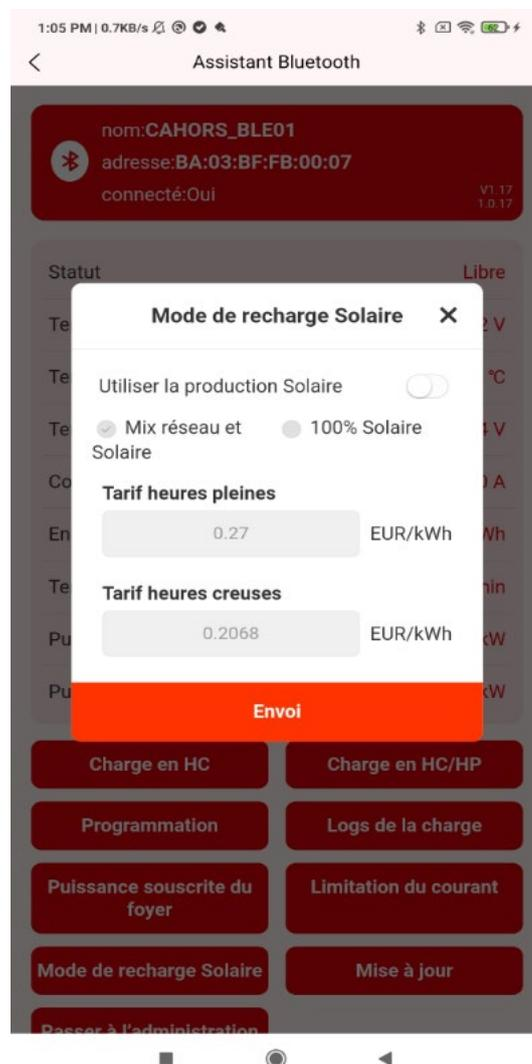
Si l'ensoleillement est insuffisant dans un des deux modes, la charge peut être forcée via le bouton latéral sur la borne, évitant ainsi de modifier la configuration par l'application.
