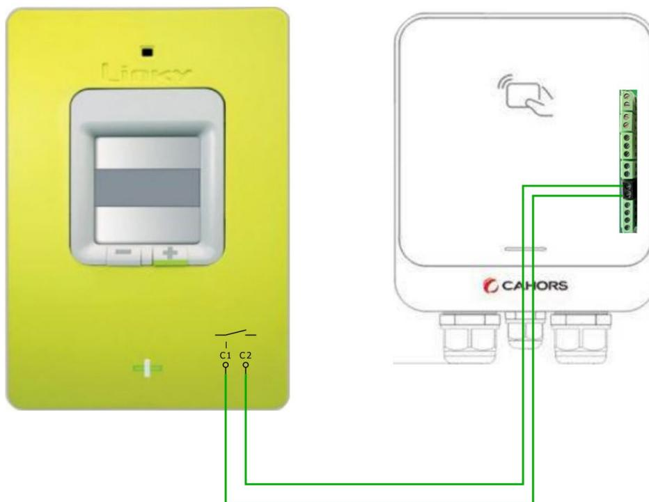
Si les contacts C1 C2 ne sont pas utilisés, ils peuvent être directement raccordés sur l'entrée contact sec de la borne l'aide de fils de section 1,5mm<sup>2</sup>.
