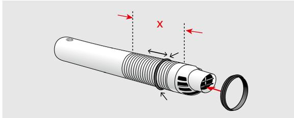
**3** Installez le terminal. Le joint doit être positionné à l'intérieur du tube existant.
