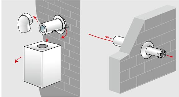
**2** Mesurez la longueur du tube en place dans le mur afin de positionner le joint d'étanchéité.
