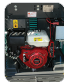
LARGE OUVERTURE DU CAPOT MOTEUR POUR UN ENTRETIEN FACILITÉ (ESSENCE)
