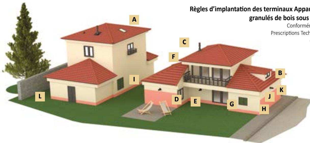
**A** Zone d'interdiction par rapport à une fenêtre de toit ou une entrée d'air
