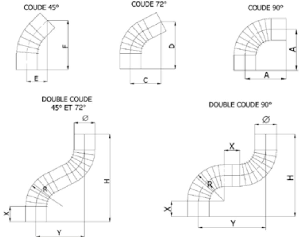
Tableaux de dimensions X = emboîtement de 60 mm
