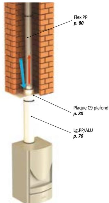
Air pris dans le conduit et par le terminal extérieur
