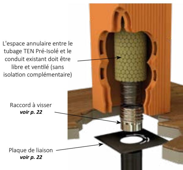
À l'intérieur d'une hotte le procédé TEN Pré-Isolé peut être raccordé directement à l'appareil, l'isolant en laine de roche entourant le flexible métallique peut être conservé dans la hotte.
