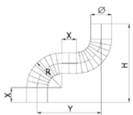
Tableaux de dimensions X = emboîtement de 60 mm
