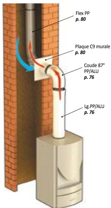
Air pris dans le conduit et par le terminal extérieur
