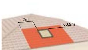
**B** Zone d'interdiction par rapport à un ouvrant en toiture
