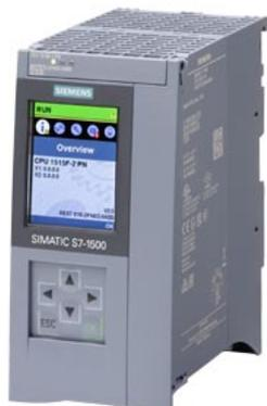
SIMATIC S7-1500F, CPU 1515F-2 PN, CPU avec 1,5 Mo de mémoire de travail pour le programme et 4,5 Mo pour les données, 1ère interface : PROFINET IRT avec commutateur 2 ports, 2ème interface : PROFINET RT, performance sur bit 6 ns, SIMATIC Memory Card nécessaire \*\*\* respecter les homologations et les certificats conformément à la contribution 109817466 sur ! \*\*\*
