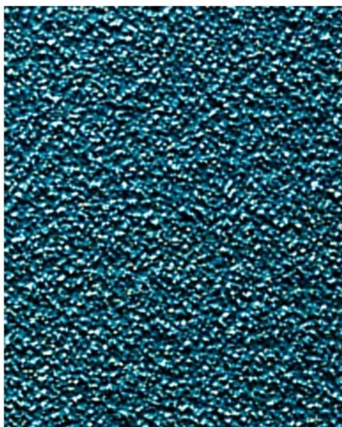
Polyvalent, pour le ponçage et l'ébavurage de l'acier et des métaux non ferreux, également adapté aux exigences élevées. Développé en collaboration avec les professionnels du ponçage, cet abrasif se distingue par sa durée de service et sa performance élevées ainsi que par son utilisation économique. Toile polyester très épaisse, liant en résine synthétique avec corindon zircon.
