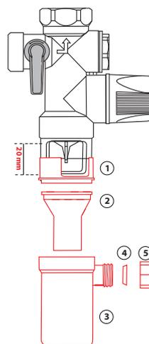
ATTENTION : Le déflecteur doit être installé selon le dessin ci-contre de façon à respecter la côte de **20 mm** minimum. Cette position protège efficacement des projections d'eau en cas d'ouverture du groupe.
